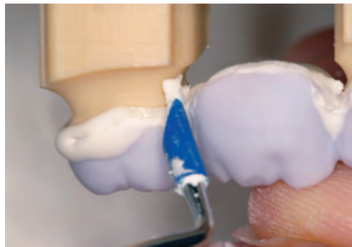
Abb. 28 Eventuelle Rückstände des IPS e.max CAD Crystall./Connect werden mit einem flachen Pinsel vollständig entfernt.
